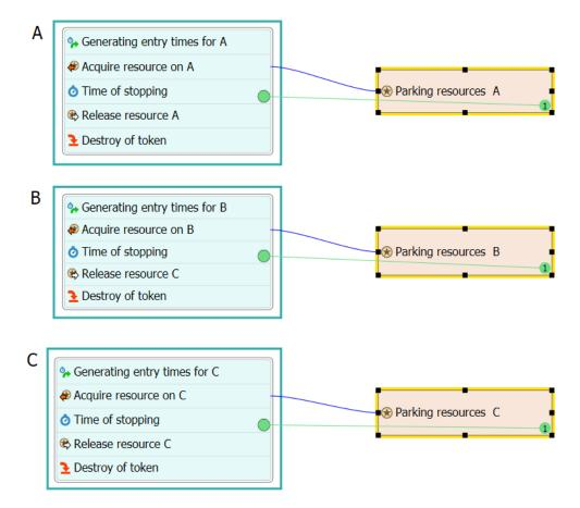
Figure 4. Block diagram of the computer model for the implementation of events in car parks A, B, C Rysunek 4. Schemat blokowy modelu komputerowego do realizacji zdarzeń na parkingach A, B, C Source: own studies.
