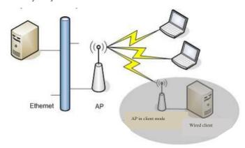
Figure 9. A Network with infrastructure (AP in customer mode, wired client) Rysunek 9. Sieć z infrastrukturą (AP w trybie klienta, klient przewodowy) Source: [Laboratorium lokalnych...].
