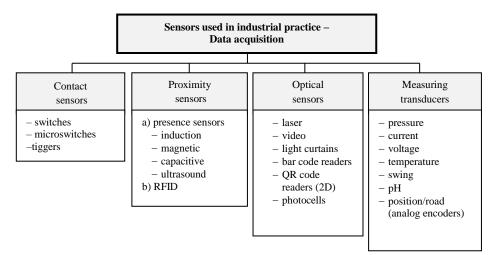
Figure 2. The division of sensors used in industrial practice for collecting data Rysunek 2. Podział czujników stosowanych w praktyce przemysłowej do zbierania danych
