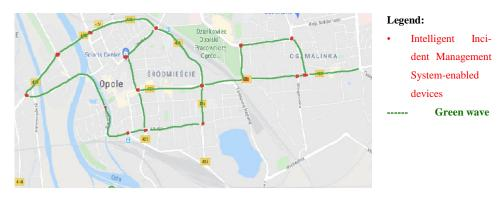
Figure 8. Graphical layout plan for traffic signal control system. Rysunek 8. Graficzny plan zagospodarowania systemu sterowania sygnalizacją świetlną Source: own study based on Google Maps.
