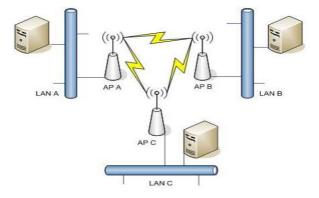
Figure 11. Bridge point to multipoint Rysunek 11. Most z punktu do wielopunktu Source: [Laboratorium lokalnych...].
