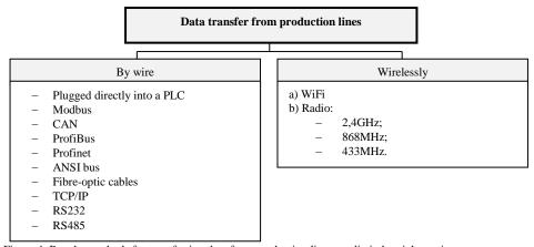
Figure 4. Popular methods for transferring data from production lines usedin industrial practice Rysunek 4. Popularne metody przesyłania danych z linii produkcyjnych stosowane w praktyce przemysłowej Source: own study based on [Blokdyk 2020].
