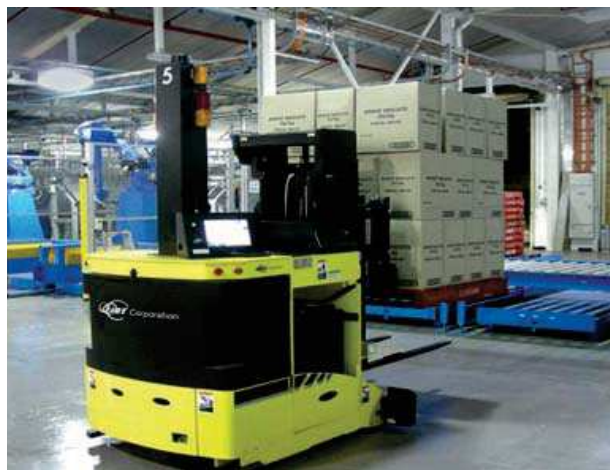
Rysunek 4. Bezobsługowy wózek widłowy AGV
