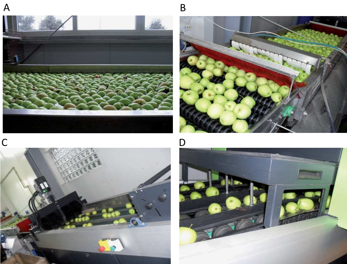
Rysunek 4. A – kąpiel wodna owoców, B – oczyszczanie i suszenie owoców, C – selekcja owoców, D – system wizyjny analizujący jakość zewnętrzną owoców
