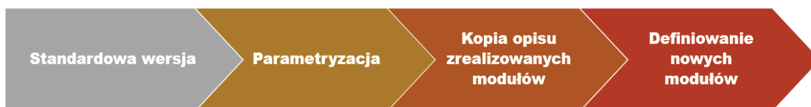
Rysunek 6. Schemat przygotowywania specyfikacji funkcjonalnej systemu WMS Logifact Figure 6. Scheme for preparing the functional specification of the WMS Logifact system
