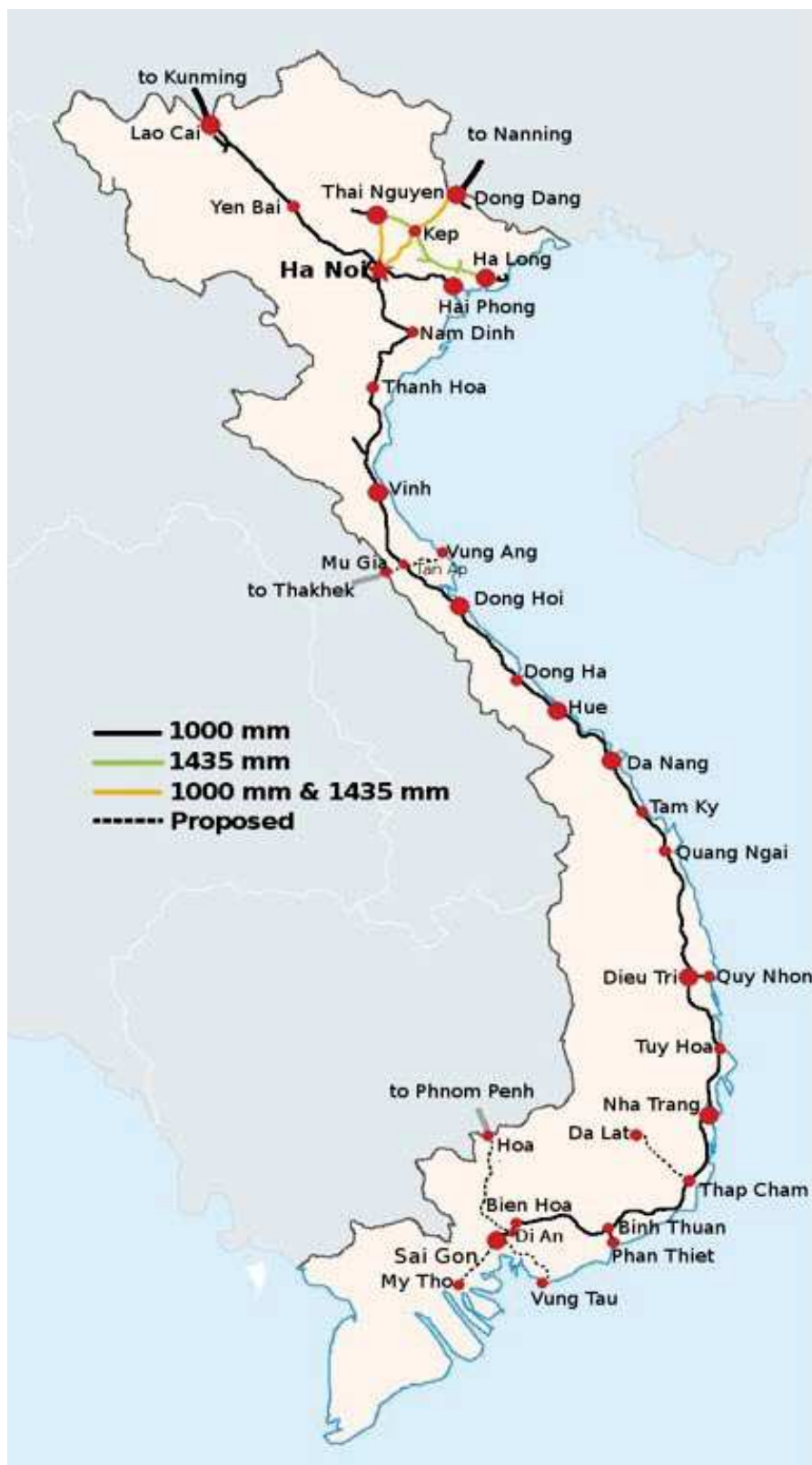
Rysunek 9. Schemat sieci kolejowej Wietnamu Figure 9. Diagram of Vietnam's railway network
